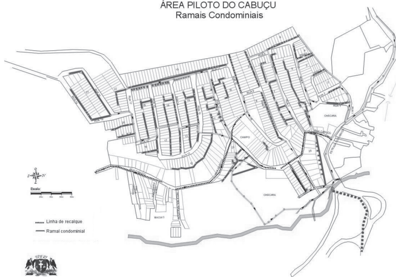
Figura 34: Projeto Piloto do Sistema Condominial de Esgotos em Guarulhos. Fonte: SAAE - Serviço Autônomo de Água e Esgoto de Guarulhos.
